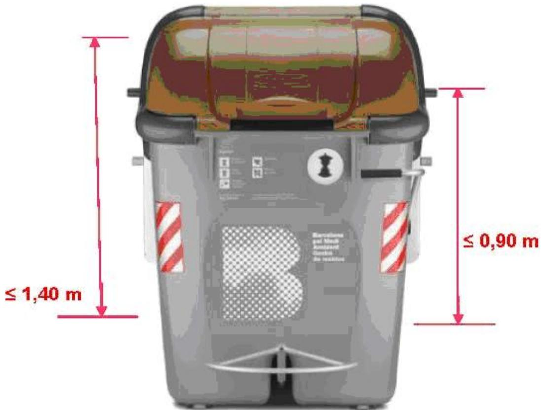
Diseño de un contenedor no enterrado y enterrados accesible.
